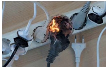
Рис. 8.3. Перевантаження за паралельного з'єднання споживачів електричного струму
