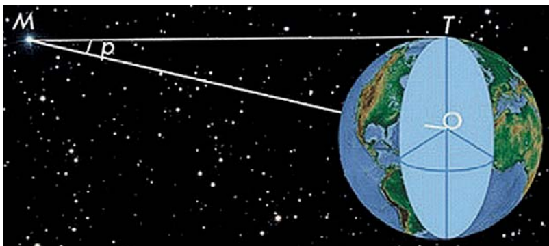
Рис. 29.5. Кут між напрямком на світило M (що перебуває на горизонті) з якої-небудь точки T земної поверхні і напрямком із центра Землі O називають горизонтальним паралаксом p світила
