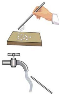
Рис. 1.1. Наелектризована скляна паличка притягує шматочки паперу та тонкі струмені води
