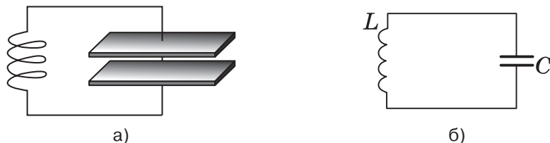
Рис. 16.3. Модель (а) та електрична схема (б) коливального контура
