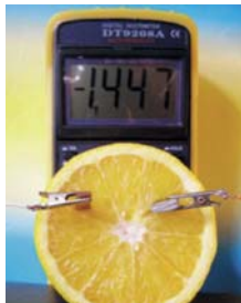
Рис. 7.4. Саморобне хімічне джерело струму
